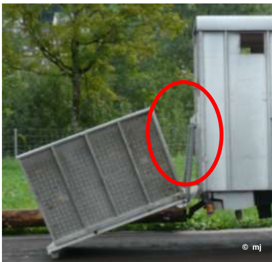
Nicht zulässiger Abstand zwischen Fahrzeug und Rampenseitenschutz
