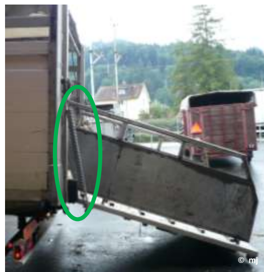
Korrektter Übergang zwischen Fahrzeug und Rampenseitenschutz
