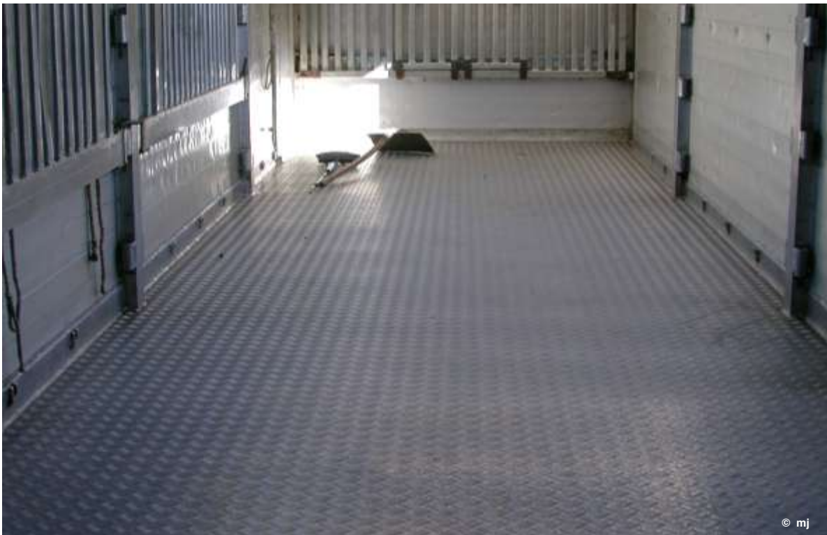
Dichter, wasserundurchlässiger Boden mit spritzwasserdichten Wänden.
